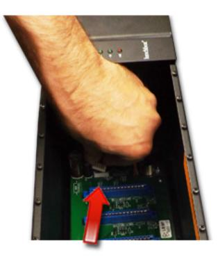
REATTACH CONNECTOR ONCE BACK PANEL HAS BEEN SCREWED BACK ON
