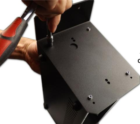
ATTACH RACK EARS AND SCREW ON ALL FOUR SCREWS AS SHOWN
